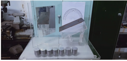
图 7 根茬与土壤滑动摩擦角测定装置
