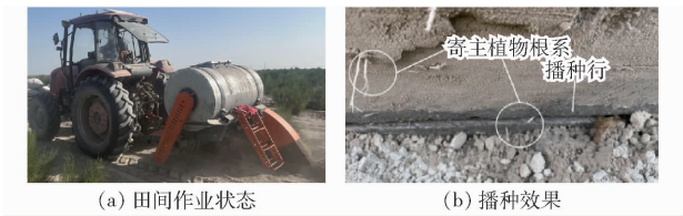
图11 肉苁蓉播种机田间试验
