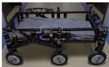
图 9 六轮多模式移动机器人样机
