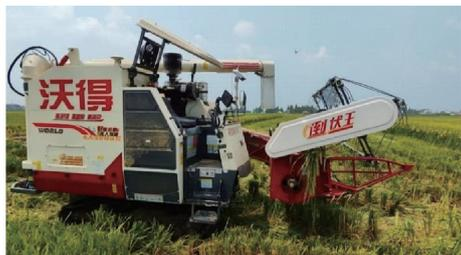
图 4 再生稻收获机自主作业试验平台
