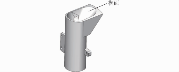
图 4 暂存盒结构示意图 Fig.4 Schematic of temporary storage box structure
