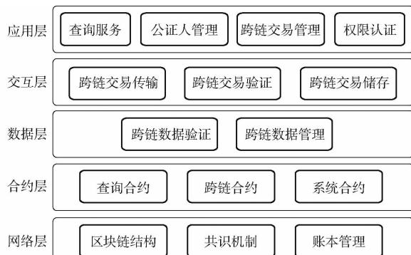
图 3 系统架构图
