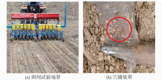
图 17 穴播器田间试验 Fig. 17 Field tests of burrow planter
