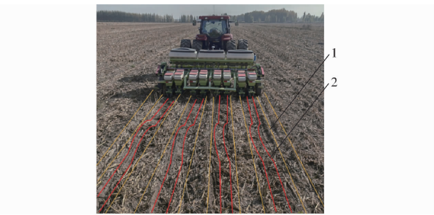
图 17 田间试验调偏效果图 Fig. 17 Field test bias adjustment effect 1. 玉米根茬行 2. 机具轨迹线
