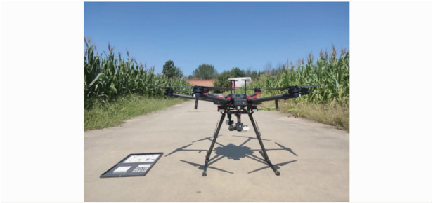
图 2 无人机多光谱影像采集系统 Fig. 2 UAV for acquiring multispectral images
