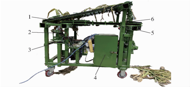
图 8 按压式切根装置台架试验
