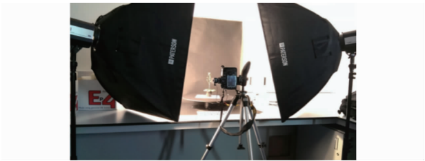
图 1 多视角二维图像拍摄装置 Fig. 1 Multi-view 2-D imaging setup
