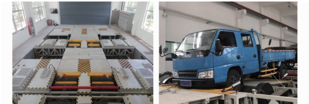
图 9 农用运输车制动性能试验台
