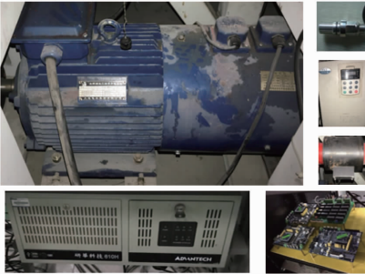
图 5 空载电机测试 Fig.5 Test of no-load motor
