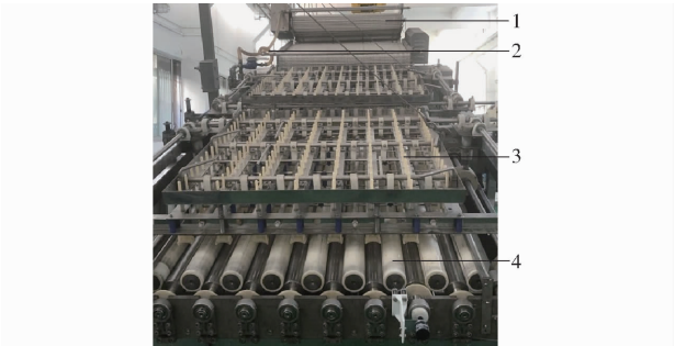
图 1 辊轴式对虾剥壳机
