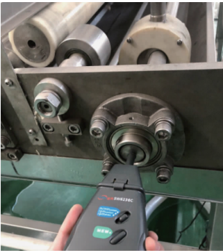
图 13 挺杆频率测量
