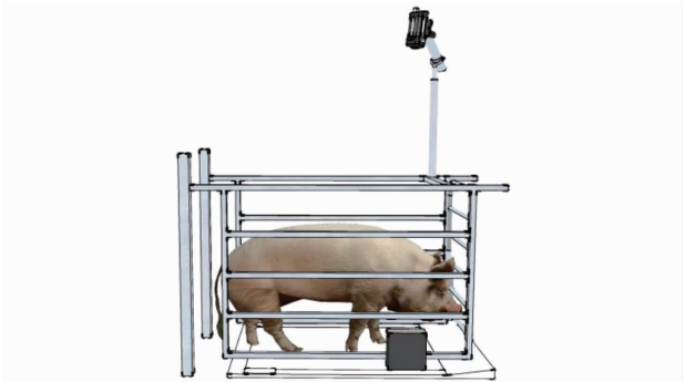
图1 热红外视频采集平台示意图
