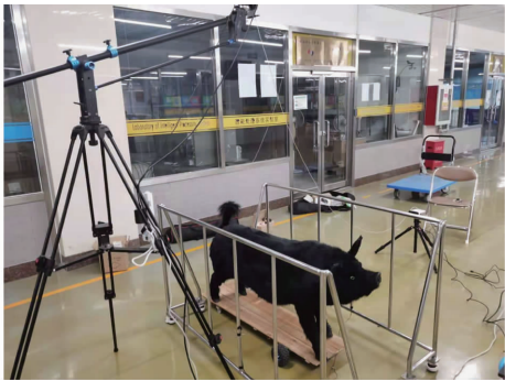
图1 模型猪视频数据采集平台
