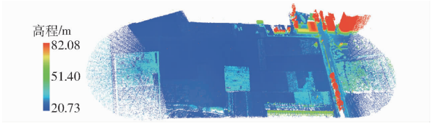
图 10 无人机 LiDAR 测量试验结果
