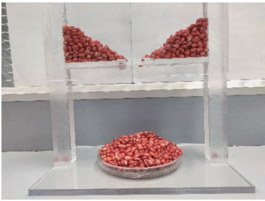
图 3 实测落种试验 Fig.3 Actual seed drop test
