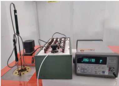
图 11 恒温槽性能测试系统配套仪器
