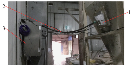
图 1 资源亚太近红外光谱在线检测系统
