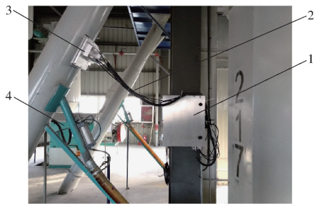
图 2 三元禾丰近红外光谱在线检测系统
