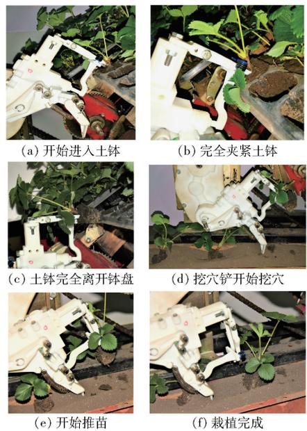
图 11 移栽机构关键位置
