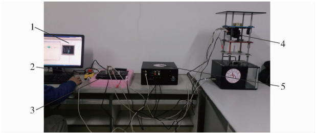
图 8 主动悬架系统实验台 Fig. 8 Active suspension system workstation 1. QUARC 实时快速成型软件 2. 急停开关 3. 数据采集卡 4. 两自由度主动悬架系统 5. 功率放大器
