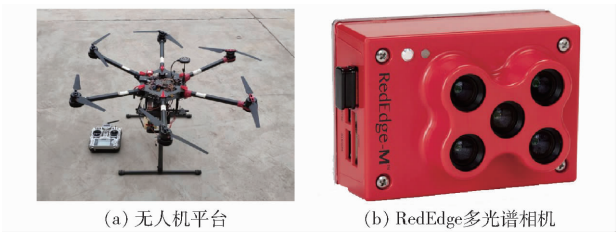
图 2 无人机多光谱系统 Fig. 2 UAV multispectral images acquisition system
