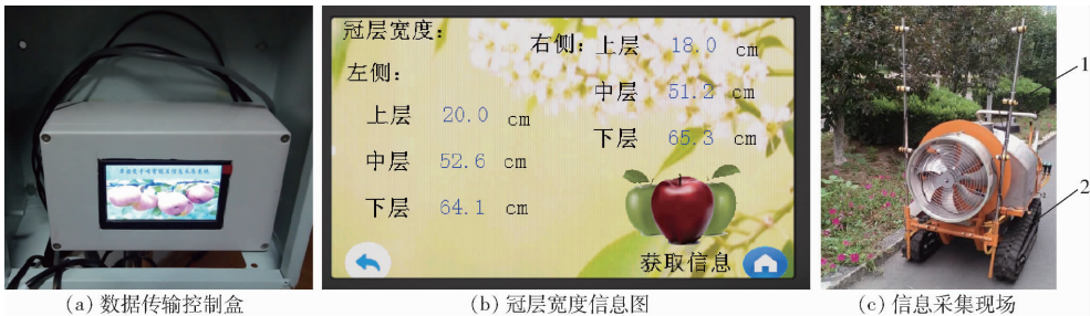
图 2 果树冠层宽度信息采集 Fig. 2 Information collection of trees canopy width 1. 测距传感器 2. 履带自走式喷雾机
