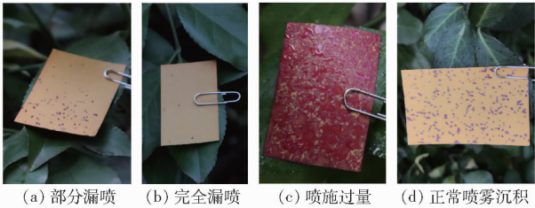
图 13 水敏纸检测雾滴沉积情况
