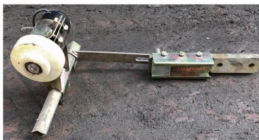
图 2 电动式振动清种装置
