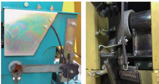
图 12 振幅调节机构
