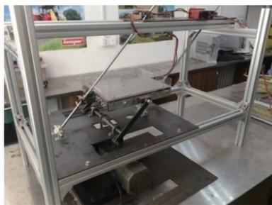
图 14 振动加热脱附试验装置
