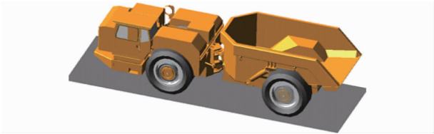
图10 基于 ADAMS 的 35 t 铰接式车辆模型
