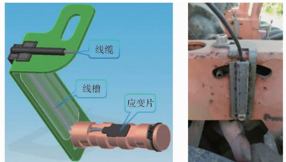
图5 下压力感知传感器总成与安装
