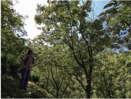
图9 仿人工拍打高空便携式山核桃采摘样机试验
