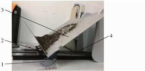
图4 基质滑动角测定
