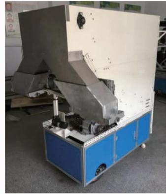
图14 基质自动移动摊铺机样机
