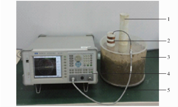
图 5 环形探头阻抗测试图 Fig.5 Diagram of ring probe impedance test 1. PVC 测试管 2. 环形探头 3. PVC 测试桶 4. 网络矢量分析仪 5. 同轴线缆
