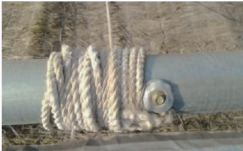
图 3 日光温室卷帘中的缠线混乱、无序叠线现象
