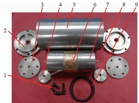
(a) 圆环流磁流变阀主要元零件
