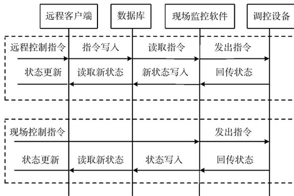
图 4 手动控制流程
