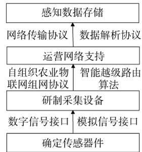
图2 农业物联网信息感知技术流程图
