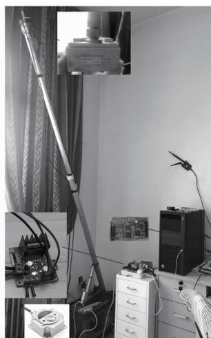
图 8 实验装置组成
