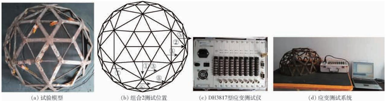
图 5 缩尺模型及应变测试系统
