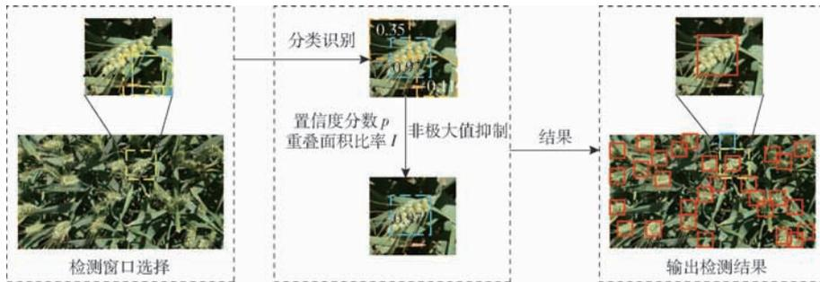
图4 基于非极大值抑制的麦穗计数流程
