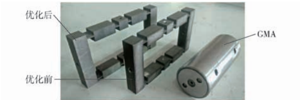
图 12 弓张结构及 GMA 样机
