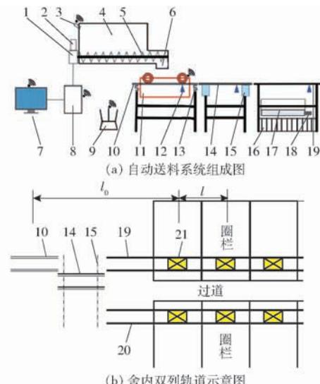
图1 猪舍饲料自动送料系统示意图
