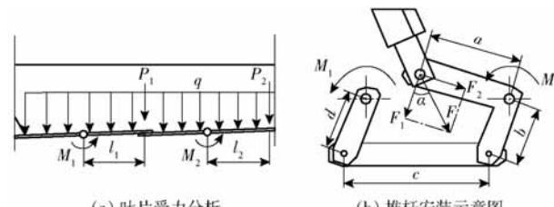
(a) 叶片受力分析 (b) 推杆安装示意图
