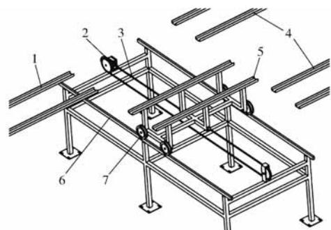
图5 平移轨道结构示意图
