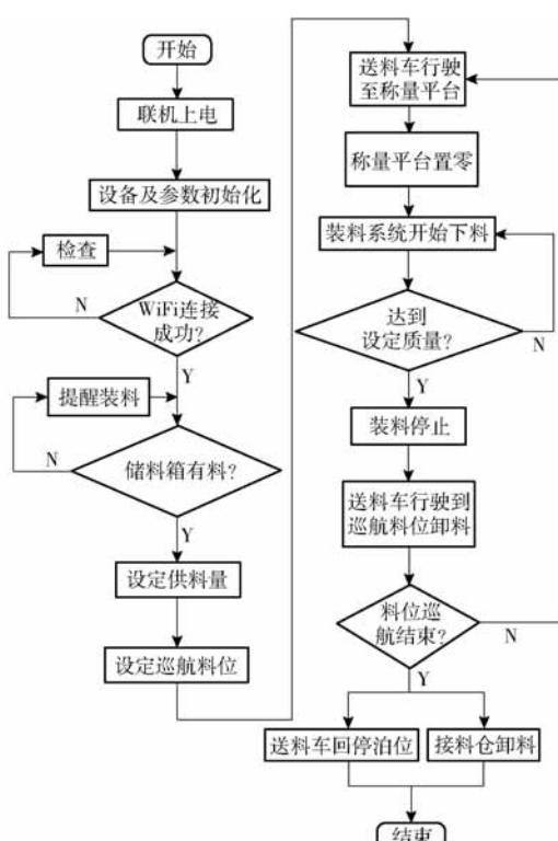
图 8 控制系统流程图
