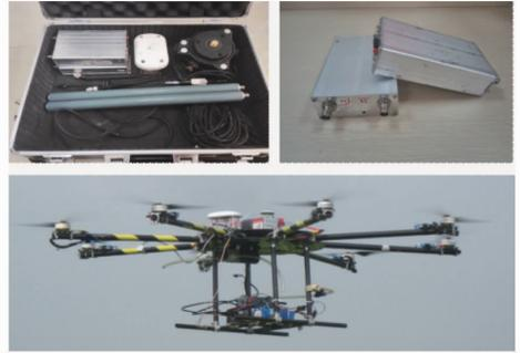
图2 无人机与机载北斗定位传感器
