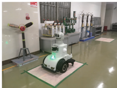
图 8 巡检导航定位试验场景
