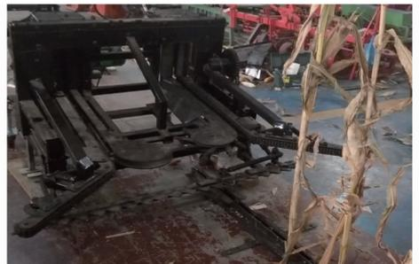
图 4 立辊式玉米收获试验台
