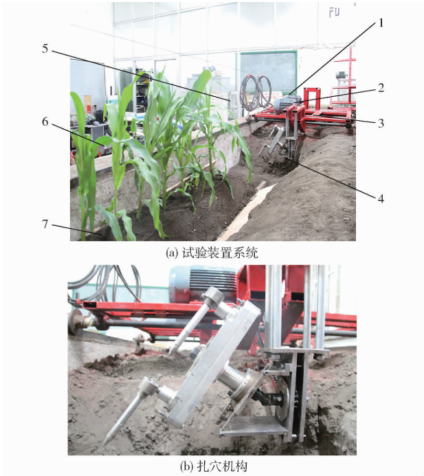
图 2 斜置式非规则齿轮行星轮系扎穴机构试验台 Fig. 2 Test-bed of non-circular planetary gear trains pricking hole mechanism for diagonal 1. 电动机 a 2. 电动机 b 3. 试验台车 4. 扎穴机构 5. 变频器 6. 玉米植株 7. 垄
