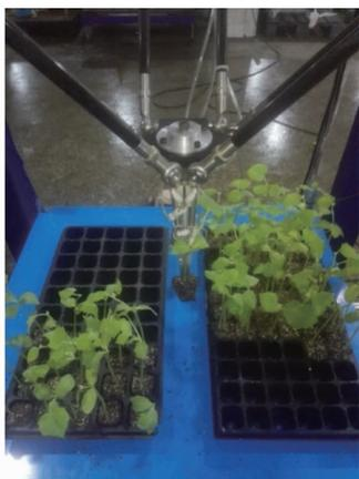
图 11 钵苗移栽试验
