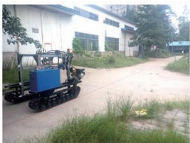
图6 作业车行驶直线性试验
