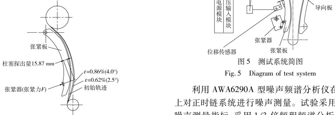
图 4 磨损伸长量对行走轨迹的影响
