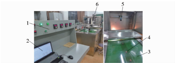
图 9 JPS-12 型计算机视觉排种器性能检测试验台 Fig.9 Computer vision seed-metering performance test bench 1.控制柜 2.计算机 3.种床带 4.微型薯 5.摄像头 6.微型薯排种器
