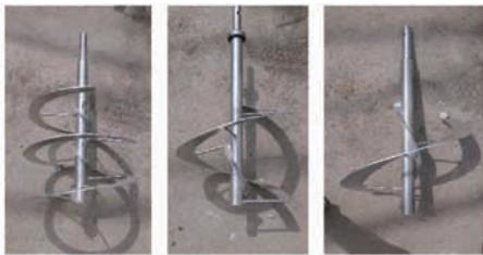
图 13 不同规格螺距搅拌叶片
