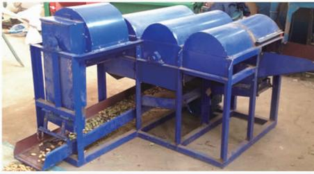
图8 多功能组合式全喂入花生摘果试验装置主体部分
