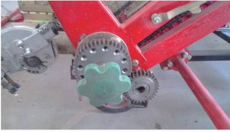
图 8 棘轮齿轮式水稻钵苗纵向送秧机构物理样机
